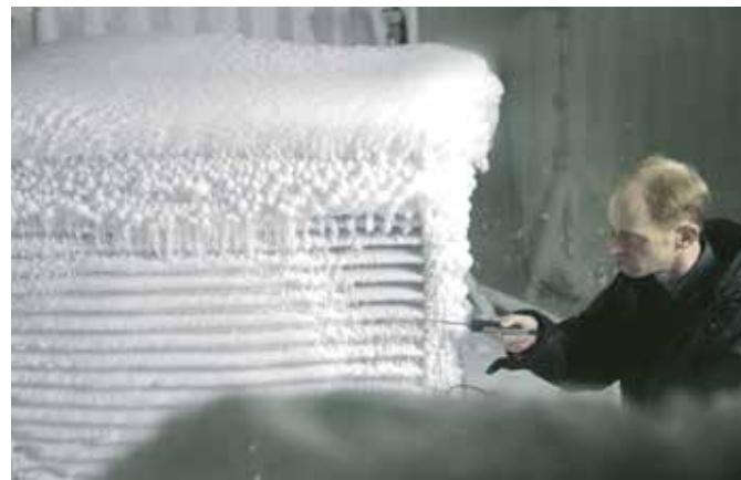
I kjølerommet testes varmepumpene under ekstreme temperaturer.
