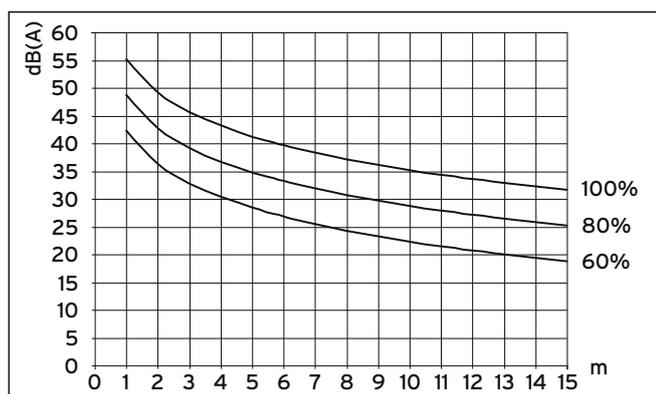
Fig. 6.4 Lydtrykknivå ved to utendørsenheter i dB(A) avhengig av avstanden og viftehastigheten for VWL 141/3 S ved ekstern installasjon
