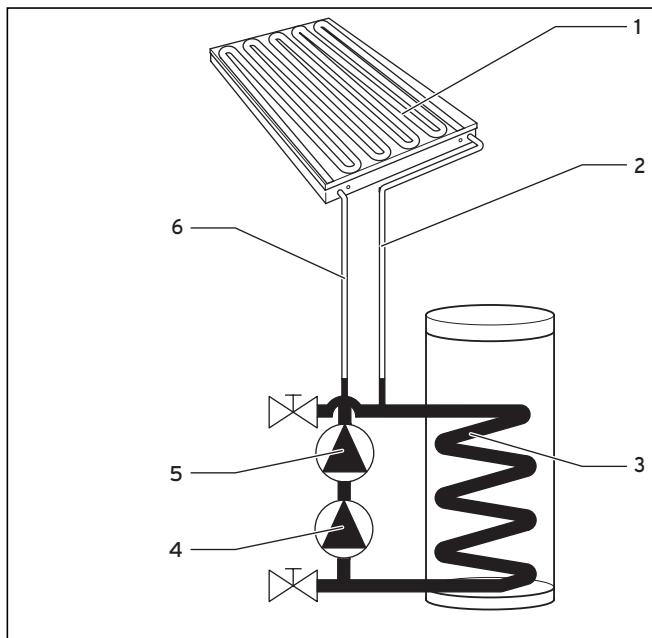
**Fig. 2.1 Fordeling av solarvæske ved stillestående kollektorpumpe(r)**
