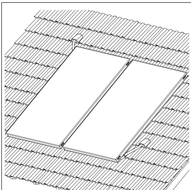
**Fig. 2.5 2 kollektorfelt auroTHERM classic VFK 135 VD (ikke tilgjengelig på alle markeder) ved takmontering**
