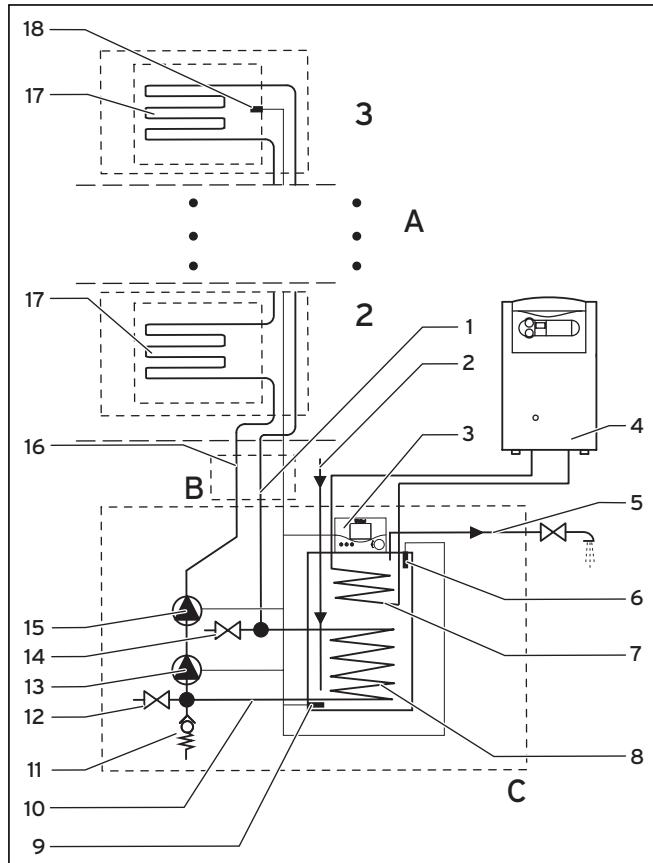
**Fig. 2.3 Hovedkomponenter for systemet euroSTEP plus med tank VIH SN 350/3 iP (prinsippsskisse uten tilkoblings-tilbehør)**
