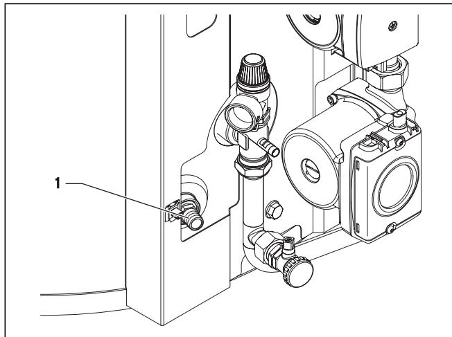
Fig. 4.2 Tømmeventil for drikkevannstank
