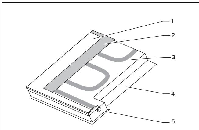
**Fig. 2.6 Snitt gjennom Vaillant-platekollektorene auroTHERM classic VFK 135 D**
