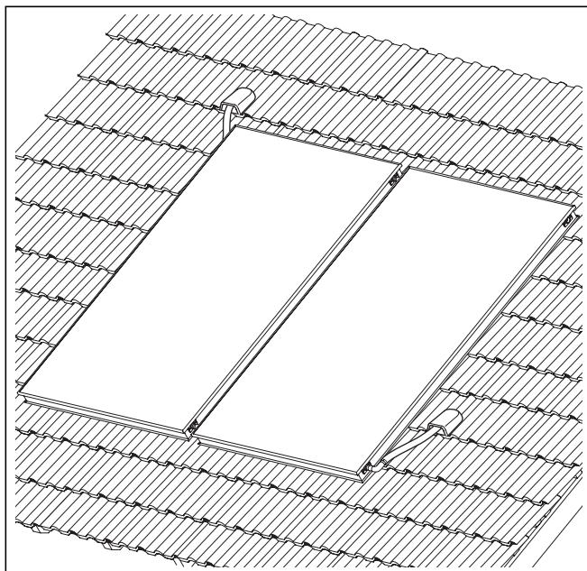
**Fig. 2.5 2 kollektorfelt auroTHERM classic VFK 135 VD (ikke tilgjengelig på alle markeder) ved takmontering**
