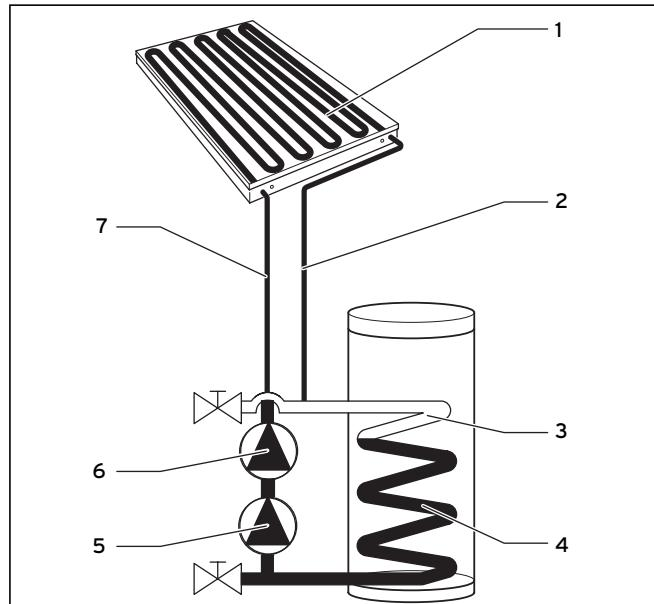
**Fig. 2.2 Fordeling av solarvæske ved kjørende kollektorpumpe(r)**
