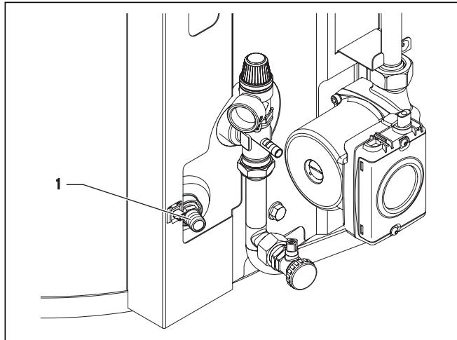
Fig. 4.2 Tømmeventil for drikkevannstank
