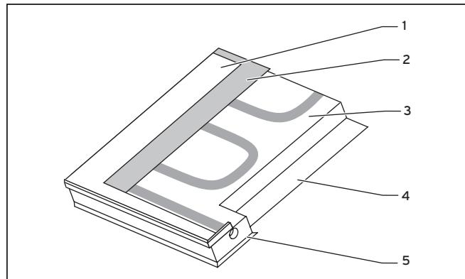
**Fig. 2.6 Snitt gjennom Vaillant-platekollektorene auroTHERM classic VFK 135 D**
