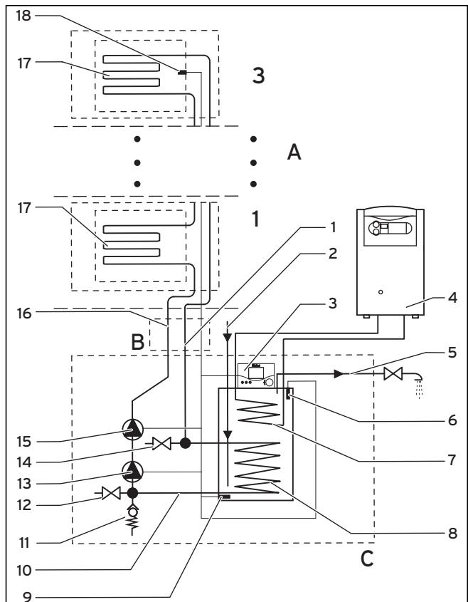
**Fig. 2.3 Hovedkomponenter for systemet auroSTEP plus med tank VIH SN 250/3 iP (prinsippskisse uten tilkoblings-tilbehør)**
